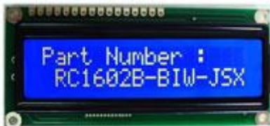
Fig. 17: Módulo Display LCD 16x2 caracteres blancos retroiluminados con fondo azul. (EBAY).
